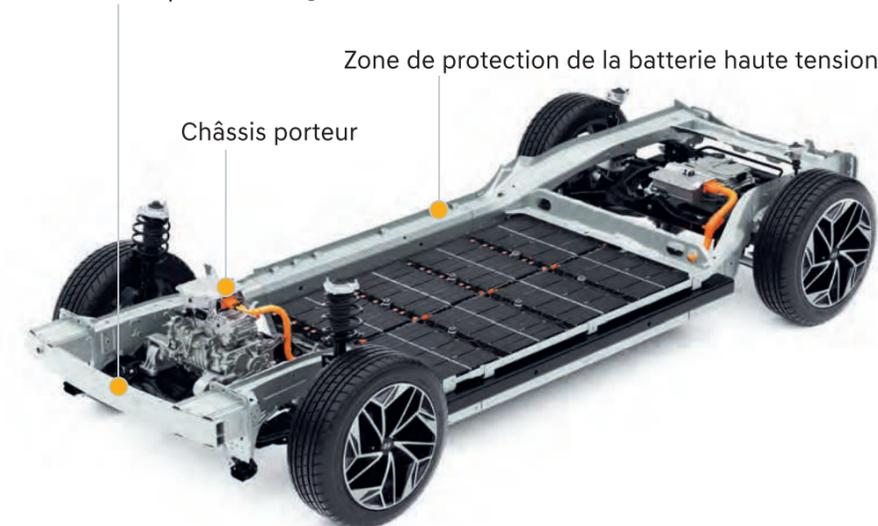
La structure à plusieurs cadres et les nouvelles technologies de sécurité fonctionnent ensemble pour protéger les passagers et préserver la batterie.
